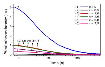
Fig-4. Decay time of CaAl<sub>2</sub>O<sub>4</sub>: Eu<sup>2+</sup> (1 % mol), Nd<sup>3+</sup> (0,5 % mol), Dy<sup>3+</sup> (x % mol)
