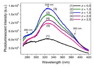
**Fig-2.** Emission spectra of CaAl<sub>2</sub>O<sub>4</sub>: Eu²+(1 % mol), Nd³+ (0,5 % mol), Dy³+ (z % mol); z = 0,5 ÷ 2,5
