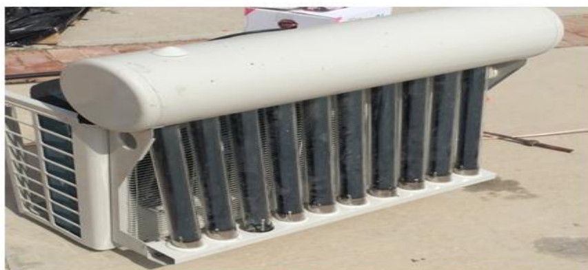
Fig-7. Solar Thermal Collector
