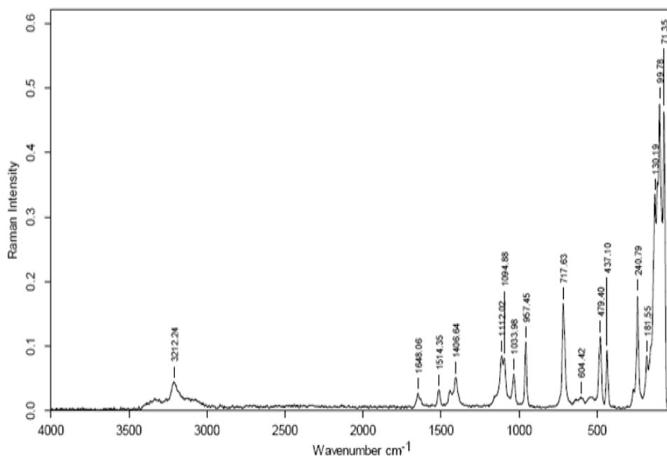
Fig-3. FT-Raman spectrum of BTSZS crystal
