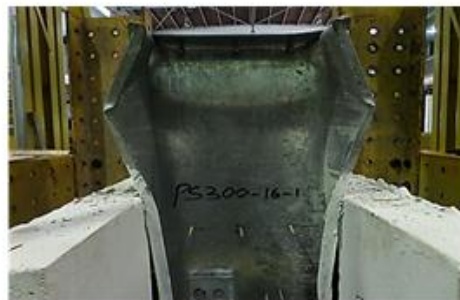
(d) CFS buckling
